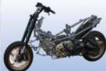
固鎖式引擎設計 接近 50:50 完美重心比
