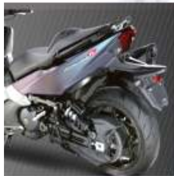
六連桿懸吊系統 搭配可調掛瓶避震器 與鍊條傳動 SINGLE- SIDED MULTI LINK REAR SUSPENSION
